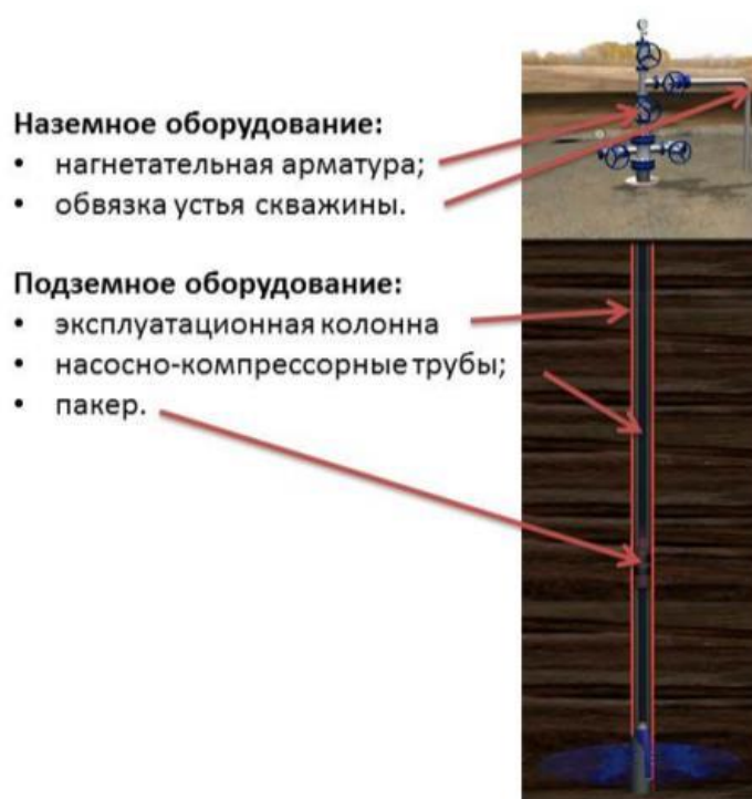
Рисунок 14 – Схема оборудования нагнетательной скважины
